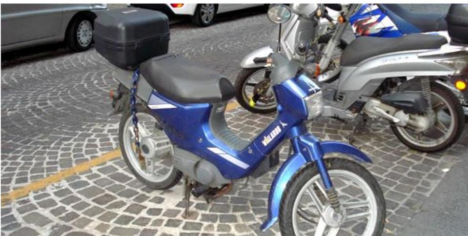
I ciclomotori sono veicoli che hanno due ruote, un motore con **cilindrata** di 50 cm<sup>3</sup> massimo e che hanno una velocità **massima** di 45 km/h.
