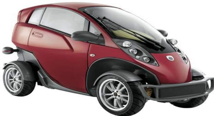
I quadricicli a motore sono veicoli a 4 ruote con **potenza** massima di 15 kW e si dividono in **quadricicli leggeri** e **quadricicli non leggeri**.
