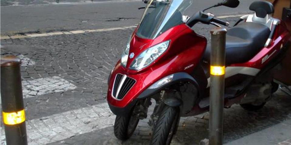
I tricicli a motore sono veicoli che hanno tre ruote **simmetriche** e un motore di cilindrata superiore a 50 cm<sup>3</sup>. Questi veicoli hanno una velocità massima **superiore** a 45 km/h.
